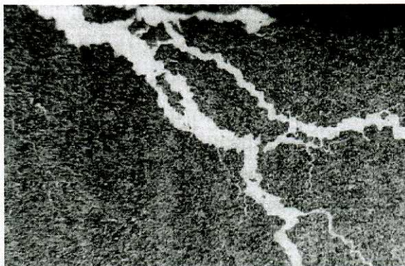
Rys. 1.1. Pęknięcie wywołane zjawiskiem LME – badanie przeprowadzono dla stali EN19 (42CrMo4) przetrzymywanej w ciekłej cynie (białe wypełnienie pęknięcia) o temperaturze 266°C [4]
