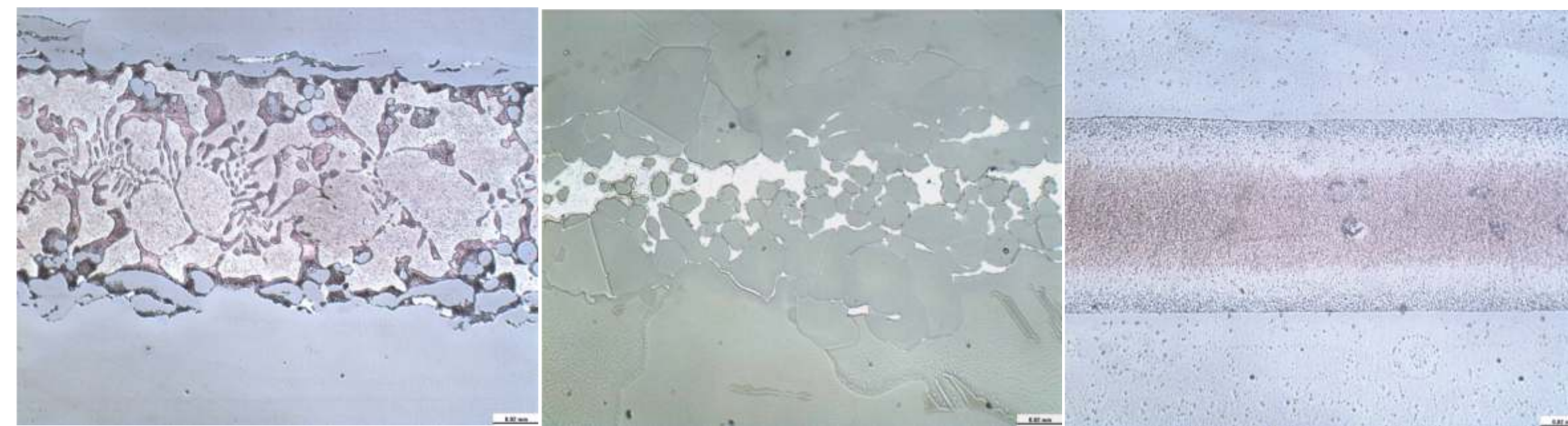
Rys. 5. Struktura połączenia lutowanego stopu Ni87Al13 wykonanego lutem B-Ag72Cu-780 w temperaturze lutowania 1000 °C i czasie 30 min. Traw. 10 ml HNO 3 + 20 ml HCl + 30 ml glicerol
