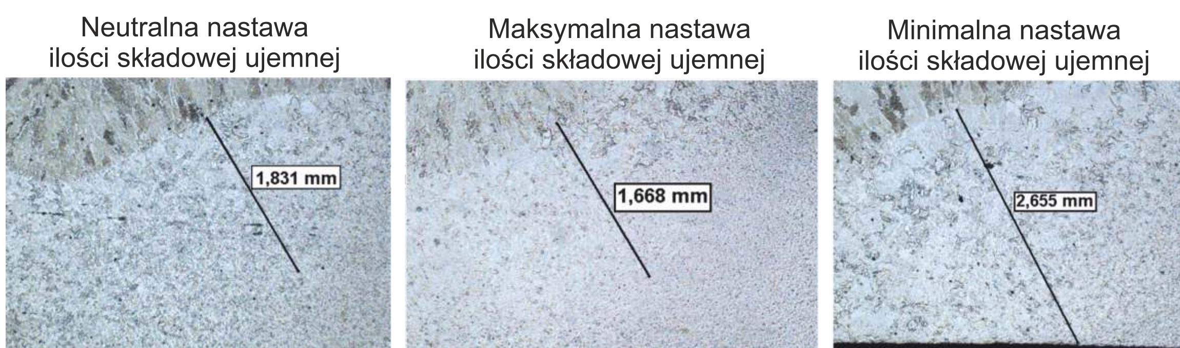
Tablica 1. Mikrostruktura oraz wynik pomiaru szerokości SWC dla nastawy neutralnej udziału składowej ujemnej. Powiększenie x 25. Trawienie Nital.
