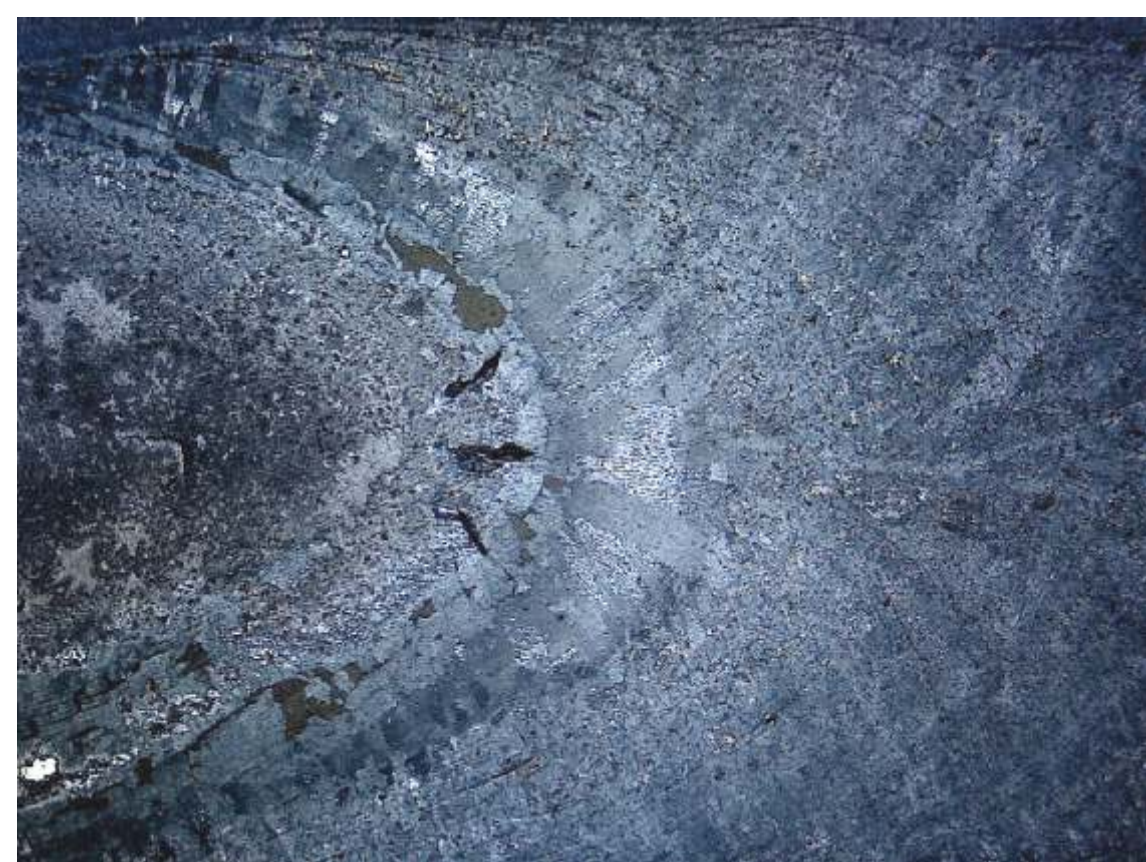
Rys. 2. Stal 304 (155) o grubości 5 mm, promień gięcia 135 mm. Lico wtopienia. Pęknięcia w obszarze L+S. Najdłuższe pęknięcie 1 mm
