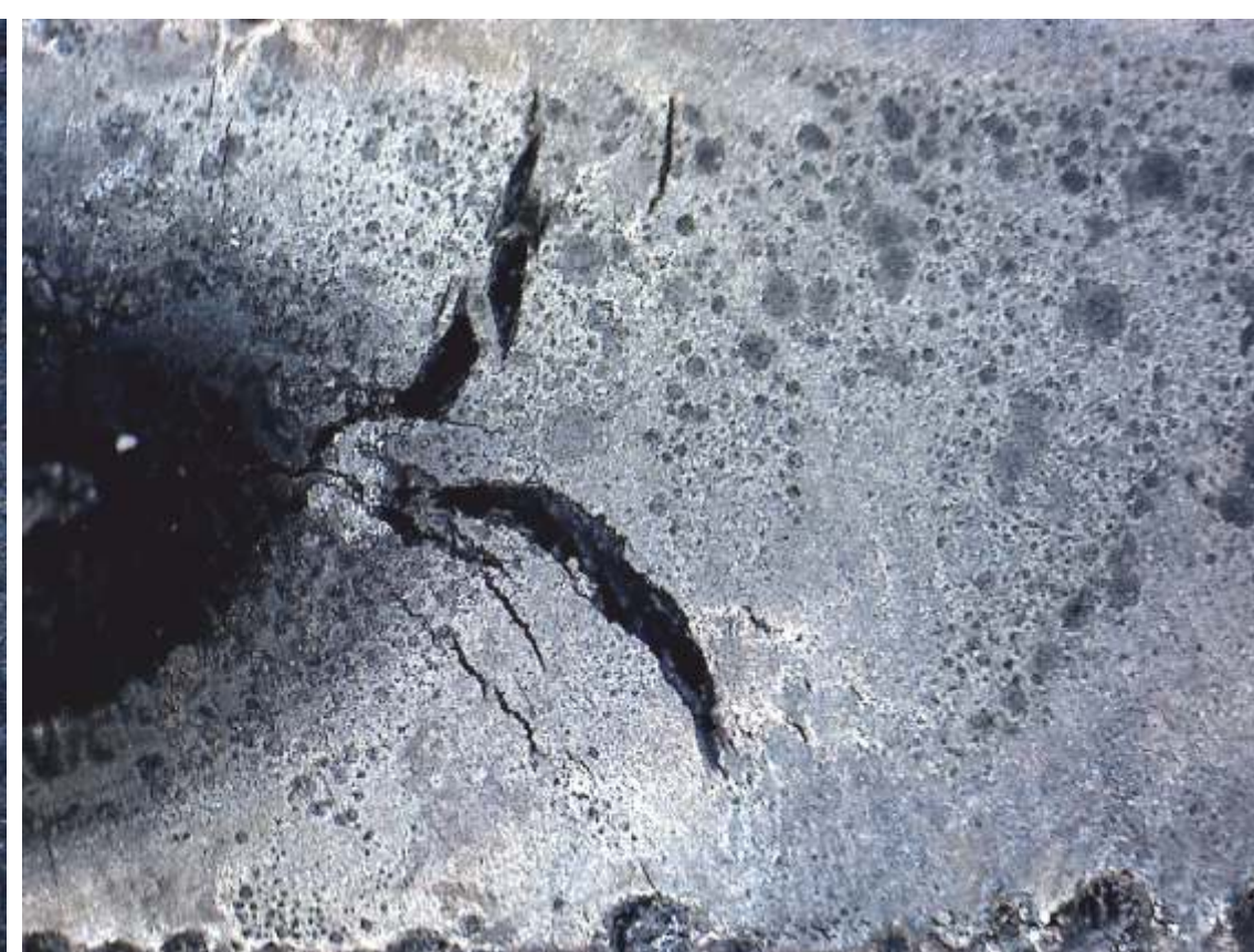
Rys. 3. Stal 314 (335) o grubości 3 mm, promień gięcia 135 mm. Lico wtopienia. Pęknięcia w obszarze L+S. Najdłuższe pęknięcie 2 mm
