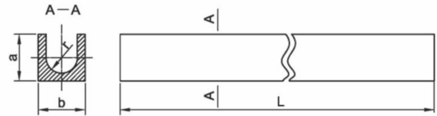
Rys. 2. Próbkę do pomiarów ilości wodoru w złączach wielościegowych: a=b=12 mm, r=4 mm, L=120 mm
