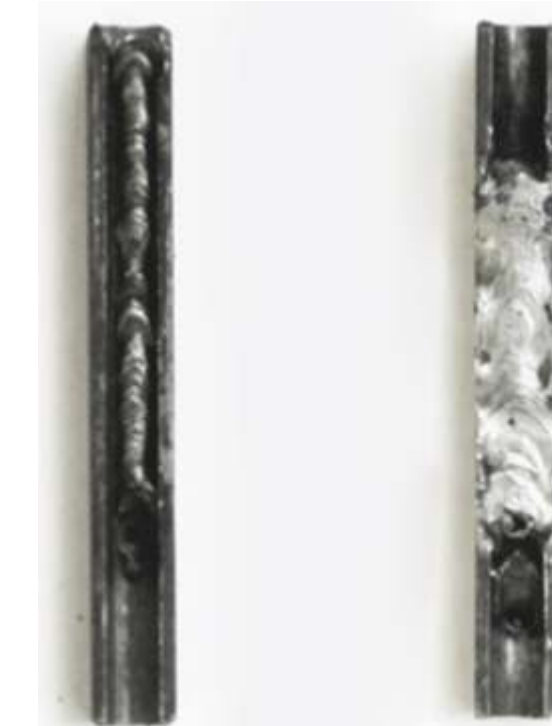
Rys. 3. Próbki z napoinami: a) próbka z jednym ściegiem (EC); b) próbka z czterema ściegami (EC+EC+EB+EB)
