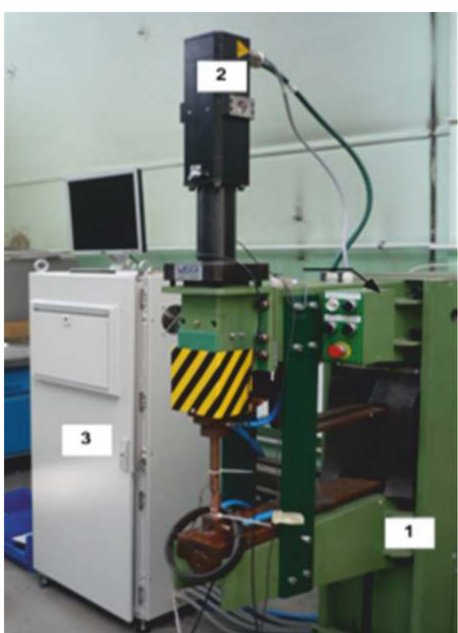
Rys. 1. Modelowe stanowisko badawcze do zgrzewania rezystancyjnego z serwomechanicznym systemem docisku elektrod (korpus zgrzewarki (1), silnik serwo (2), szafa sterownicza (3))
