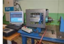
Rys. 7. Stanowisko do zgrzewania metodą HSFW stopów tytanu Ti64 oraz CP-Ti
