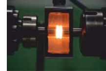
Rys. 7. Stanowisko do zgrzewania metodą HSFW stopów tytanu Ti64 oraz CP-Ti
