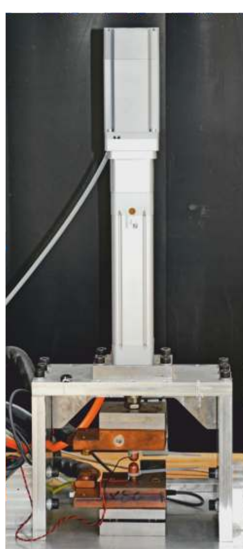
Rys. 2a. Inwertorowa zgrzewarka DC 10kHz z SED o maks. sile docisku 2kN. Widok serwo mechanizmu oraz elektrod [1]
