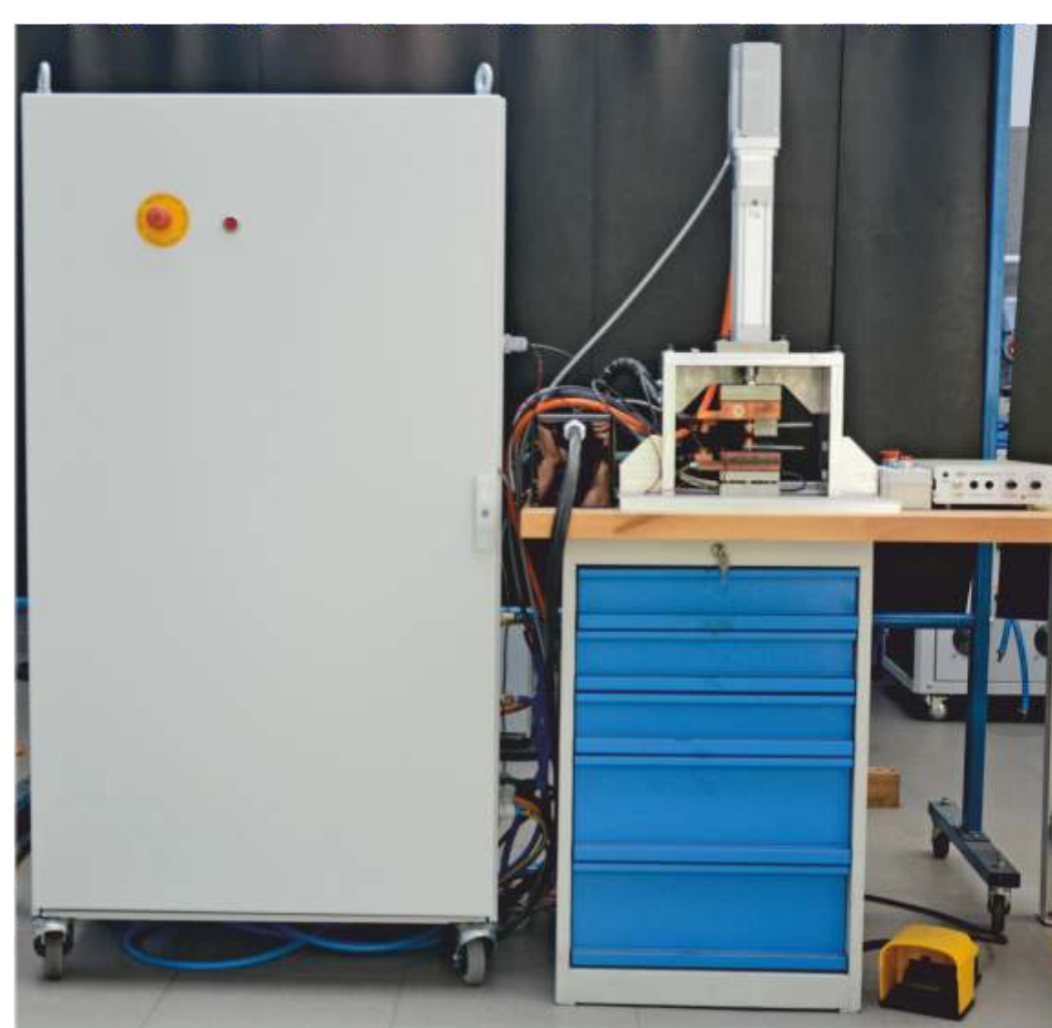
Rys. 2b. Inwertorowa zgrzewarka prądu stałego 10kHz z elektromechanicznym układem dociskowym o maksymalnej sile docisku 2kN. Widok ogólny urządzenia [1]
