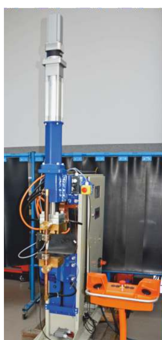
Rys. 1. Zgrzewarka AC 50 Hz z SED o maks. sile docisku 15kN [1]
