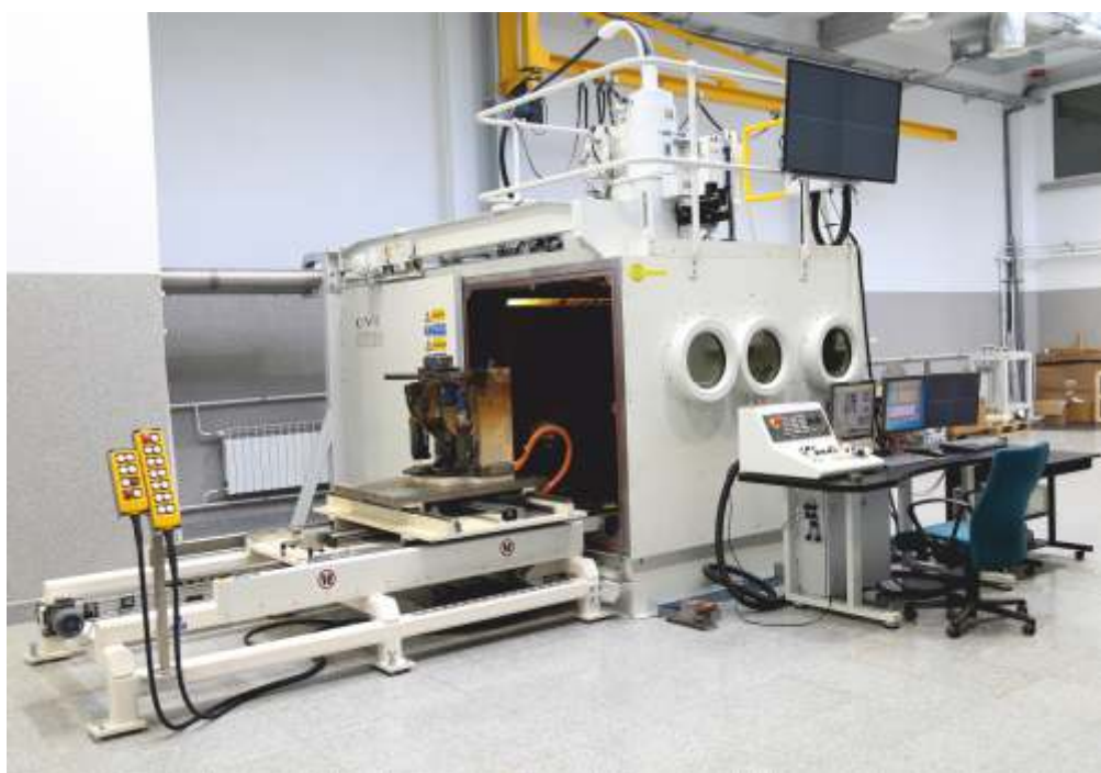
Rysunek 1. Urządzenie do spawania i modyfikowania powierzchni XW150:30/756 (CVE) – Łukasiewicz - Instytut Spawalnictwa
