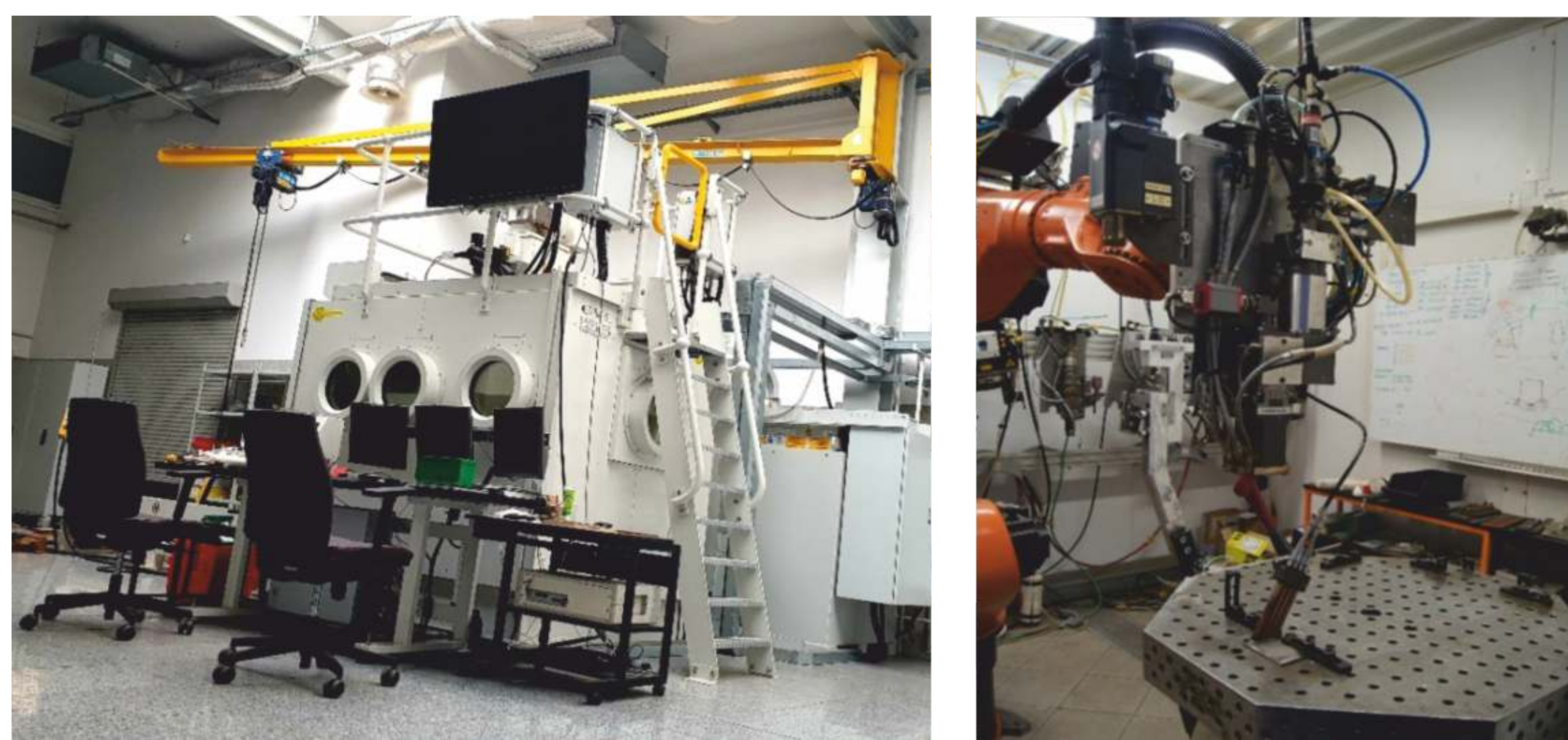
Rys. 1 a) Spawarka elektronowa CVE EB 756, b) Zrobotyzowane stanowisko do spawania laserowego
